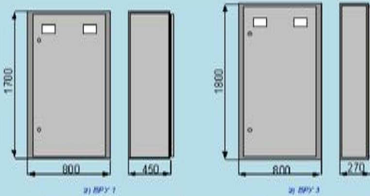
Рис. 1. Общий вид и габаритные размеры ВРУ
